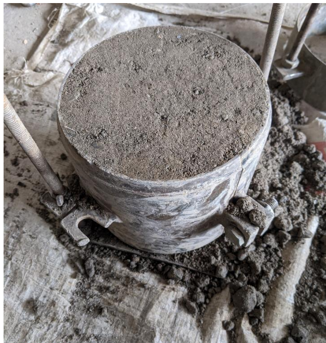
Figure 2.8 - Moule Proctor remplie du matériau compacté
