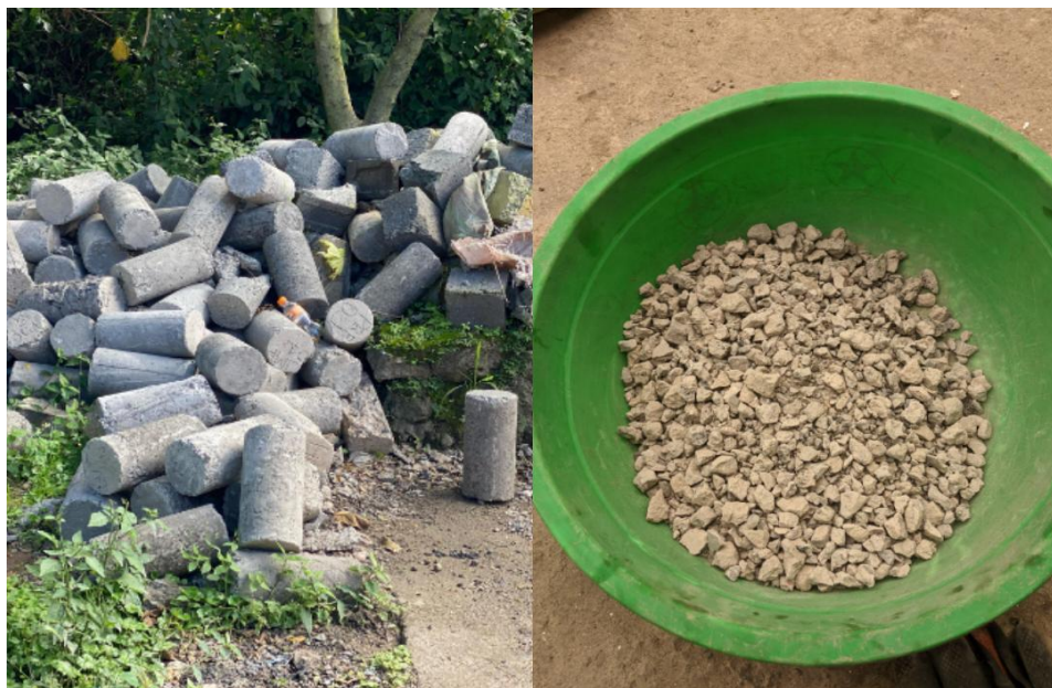
Figure 2.2 - Eprouvettes de béton / Concassage de l'échantillon 2
