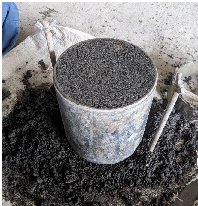
Figure 2.10 - Moule CBR remplie du matériau compacté
